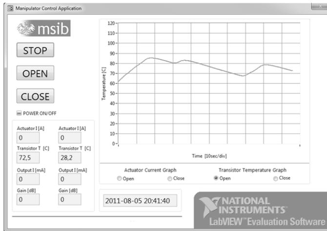
Fig. 11. The interface of the program „Manipulator Control Application”
