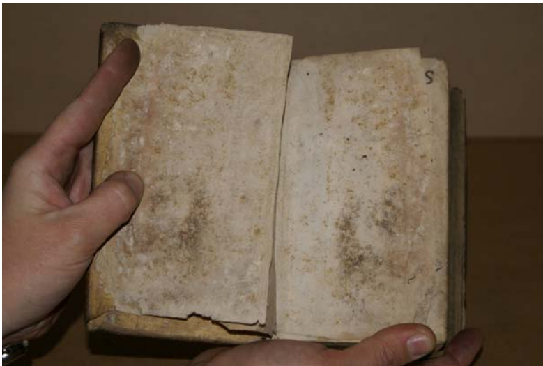
Fot. Plamy pozostawione przez intensywny wzrost grzybowy na kartach wyklejkowych książki
