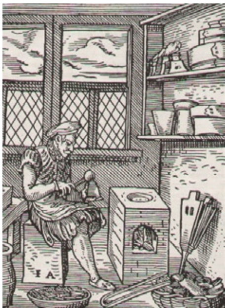
Drzeworyt Josta Ammana z 1568 r. przedstawiający odlewanie czcionek
