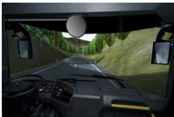
Ryc. 1. Symulator z ekranem walcowym – widok kabiny i ekranu z wyświetlanym obrazem z zewnątrz i z wnętrza kabiny (źródło: autor zdjęć G. Gudzbeler)
