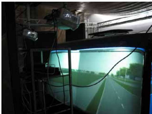
Ryc. 4. Stanowisko badawcze symulatora z ekranami „on screen” – widoczna kabina z ekranami „on screen” na szybie czołowej i projektory obsługujące szybę czołową (źródło: autor zdjęć G. Gudzbeler)
