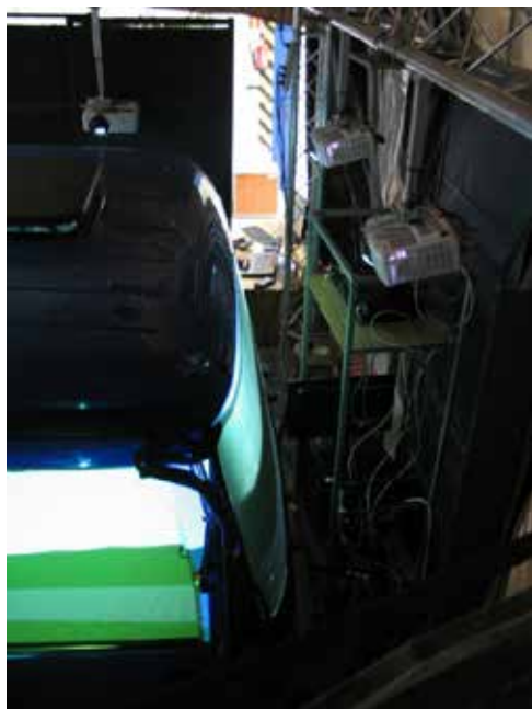
Ryc. 3. Stanowisko badawcze symulatora z ekranami „on screen” – widoczna kabina z ekranami „on screen” i projektory obsługujące szybę czołową i lewą boczną (źródło: autor zdjęć G. Gudzbeler)
