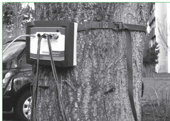
3. Tomografia impedancji elektrycznej – PiCUS Treetric. Fot. M. Kapsa.
