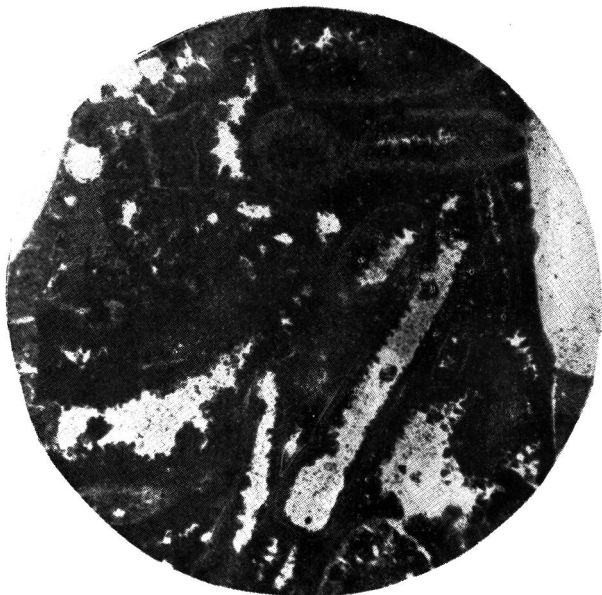
Rys. 6. Korpus zbiornika. Struktura psammitowa równomiernie ziarnista. Wypełniacz skaleniowo-kwarcowy. \times 15 . Bez analizatora.
