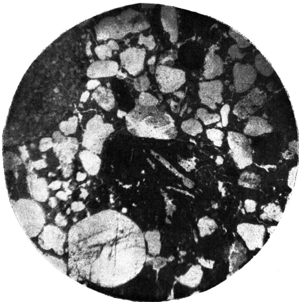
Rys. 9. Tynk wewnętrzny ściany kamiennej. Struktura psamitowa nierównomiernie ziarnista. Wypełniacz mieszany skaleniowo-wapienno-kwarcowy. \times 15 . Bez analizatora
