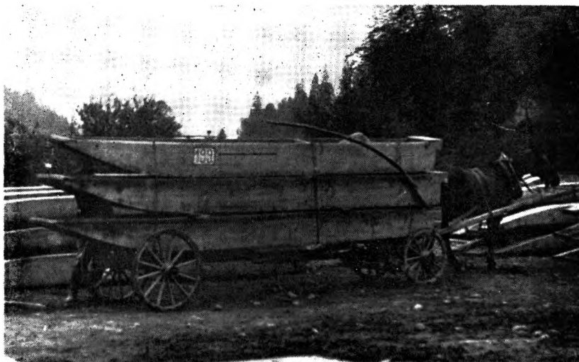
Ryc. 16. Transport zestawu trzech łodzi wozem w górę rzeki; widoczny sposób wiązania do transportu i opasanie łodzi łańcuchem
