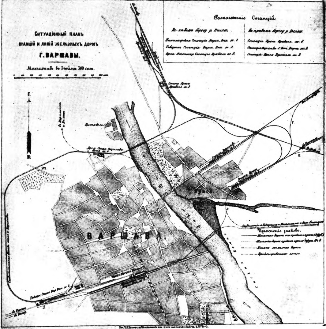
Рис. 3. План ситуационный станций и линий железных дорог в Варшаве с проектированной через инж. Флидербаума линией среднечовой („Дзйенникъ Министерства Коммуникацій”, липецъ 1879 г.) Рис. 3. План расположения станций и железнодорожных линий в Варшаве, охватывающий спроектированную инж. П. Флидербаумом диаметральную ж.-д. линию („Журналъ Министерства путей сообщения”, июль 1879 г.)
