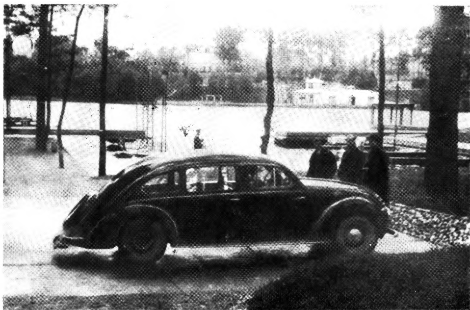
Rys. 3. Samochód osobowy Lux-sport z 1936 r. Silnik 8V o mocy 96 KM; zawieszenie niezależne na wahaczach: długich drążkach skrętnych. Siła resorowania regulowana nawet w czasie jazdy. Zbiory S. Panczakiewicza, fot. J. Tarczyński
