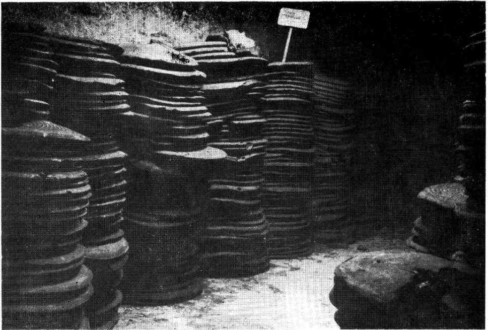
Ryc. 4. Masa fajansowa po wyjęciu z pras odpowietrzających. Fot. J. Korpai
