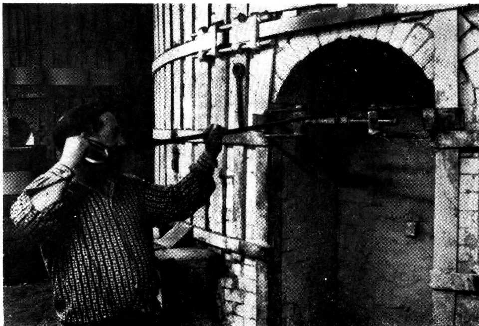
Ryc. 11. Rozbijanie furty pieca po zakończeniu procesu wypalania. Fot. J. Korpala
