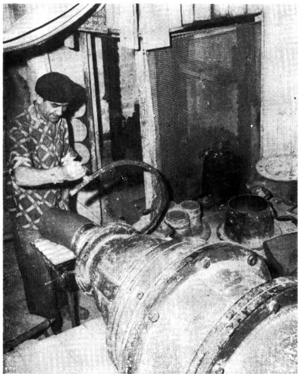
Ryc. 6. Masa fajansowa wychodząca z prasy próżni- cowej. Fot. B. Horbaczewski
