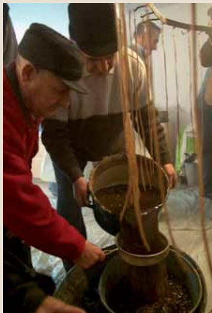
3. Cedzenie wosku przez sito to konieczny proces produkcji pozwalający uniknąć zanieczyszczenia produktu finalnego.
