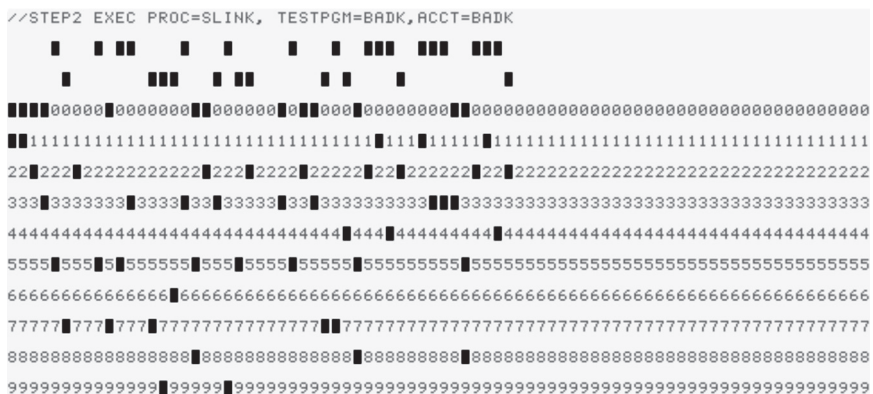
Rys. 1. Karta perforowana typu 5081
