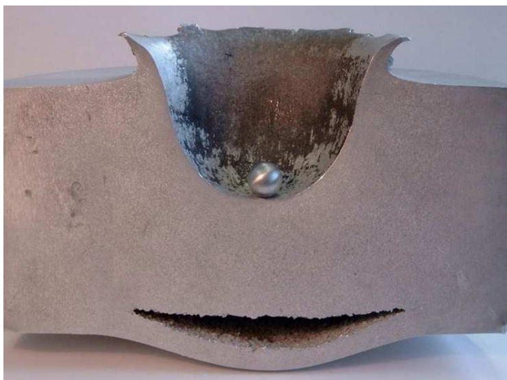
Rys. 3. Test uderzeniowy przy prędkości 7 km/s
