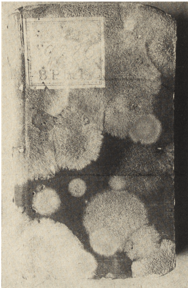
Ryc. 162. Wzrost grzybów niższych (pleśni) na oprawie płóciennej.
