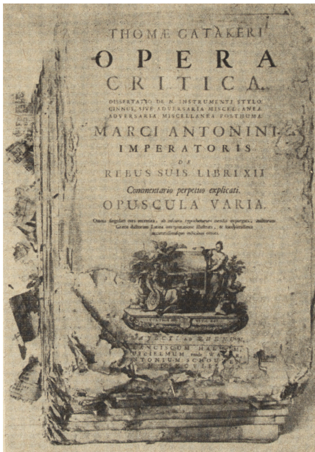
Rys. 163. Zniszczenie papieru, wywołane różnymi gatunkami mikroorganizmów.
