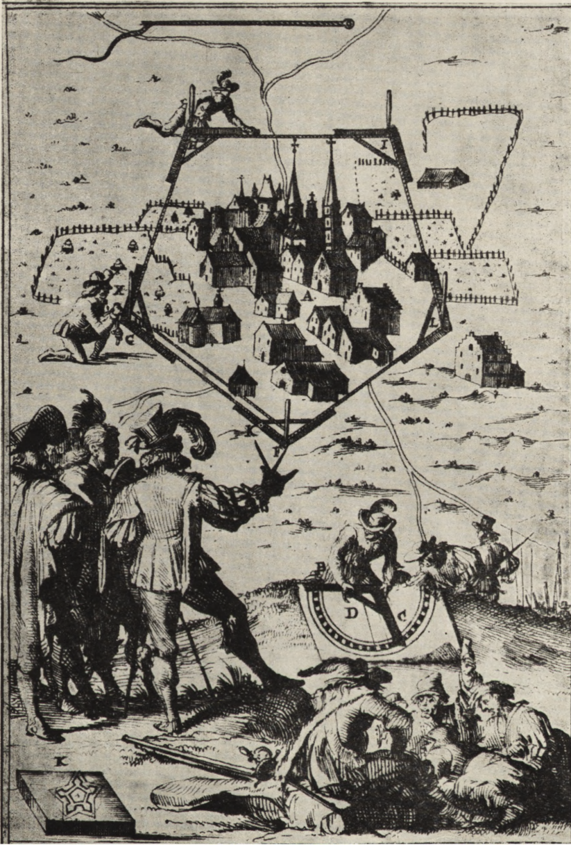
Ryc. 146. Wytyczenie figury poligonu odbywało się przez wyznaczanie okręgu z jego środka za pomocą kołka i sznura. Jeżeli z uwagi na zabudowę było to niemożliwe, wytyczano poligon przez kolejne odmierzenie kąta figury. W Krzepicach w środku stał zamek, musiano więc wytyczyć poligon w podobny sposób, jak na rycinie. W/g Allain Manesson Mallet, Der Kriegsarbeit... Amsterdam 1672 T. I s. 64.
