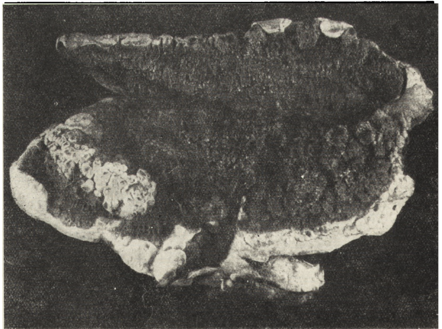
Ryc. 14. Kościół w Grywał- dzie; owocnik grzyba do- mowego Merulius lacry- mans . (fot. M. Waltherowa i W. Galewski)
