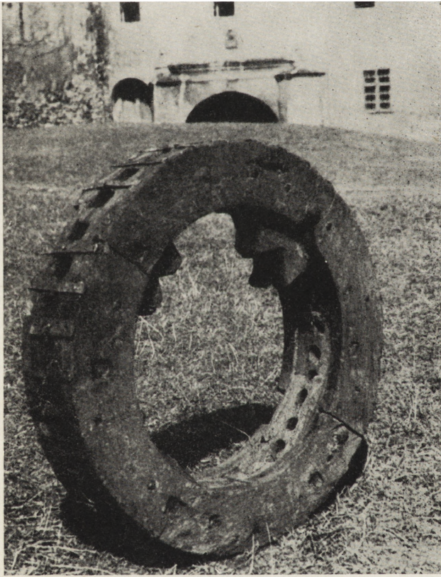
32. Tyniec. Klasztor oo. benedyktynów. Koło zębate z wyciągu studziennego (zęby nie zachowane) — stan z 1965 r. (fot. A. Saładziak)
