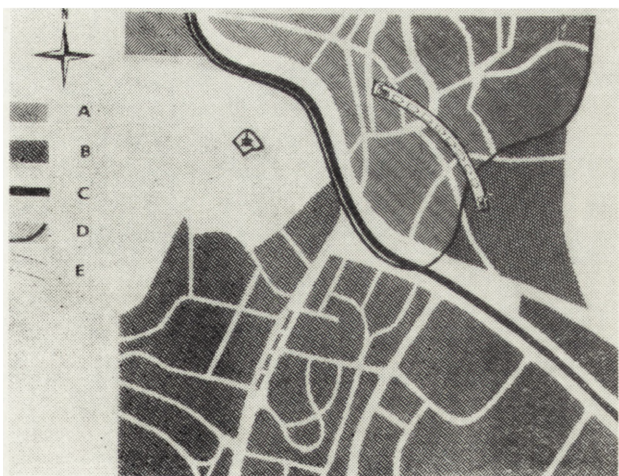
3. Schemat trasy przesunięcia kościoła w Moście; A — Stare Miasto, B — nowe miasto, C — wykop, D — rejon eksploatacji węgla, E — trasa przesunięcia kościoła
