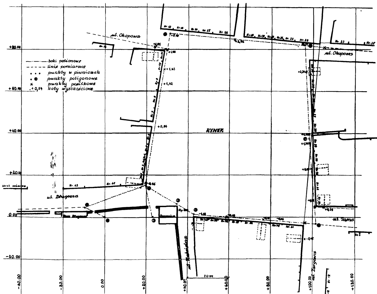
7. Wislica, rynek z mierzonymi piwnicami zabytkowymi (wszystkie rysunki z dostarczonych oryginałów przerysował J. Kalicki)
