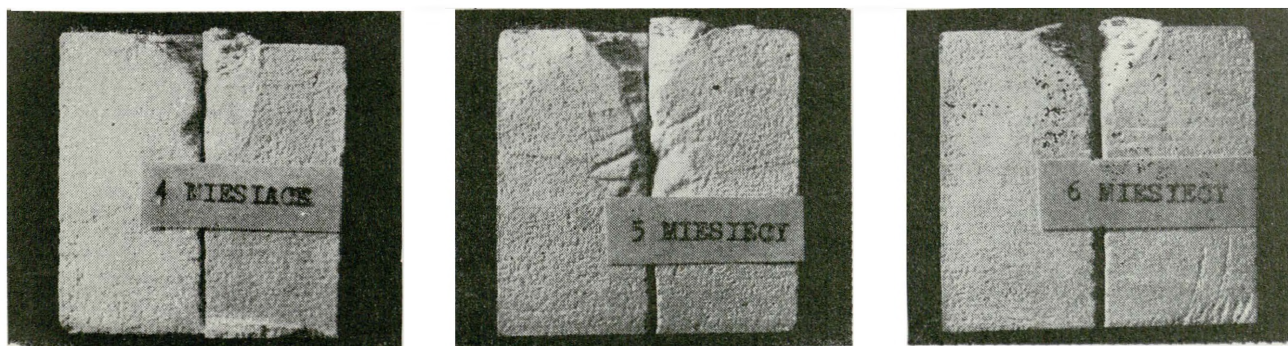
1. Przecięte próbki z proszkiem wapiennym nasycane wodorotlenkiem baru i mocznikiem przez 4, 5 i 6 miesięcy 1. Crosscut samples of limestone powder being impregnated with barium hydroxide and carbamide during the period of 4, 5 and 6 months
