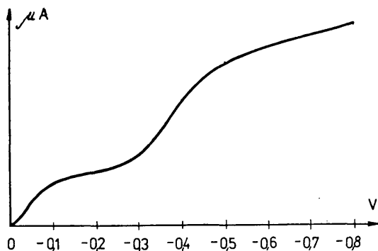
6. Folia złota pobrana z kamiennego kapitelu: roztwór podstawowy — NaOH, czułość — 1/5, tłumienie — 3, elektroda odniesienia — Hg dno (polarogram rejestrowano od potencjału 0 do -0,8 V)
