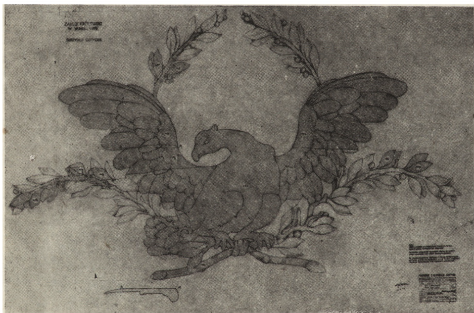
9. Pokój Audiencjonalny Stary – rysunek fragmentu dekoracji. Na zdjęciu widoczne są elementy zachowane (ciemniejsze) i odtworzone (jaśniejsze)
