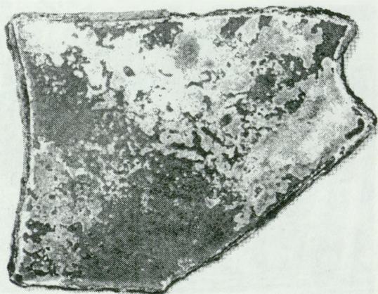
2. Korozja szkła — strona zewnętrzna, powiększenie 3 x. Fot. P. Karaszkiewicz 2. Corrosion of glass — outer surface, magnified 3 x. Photo: P. Karaszkiewicz
