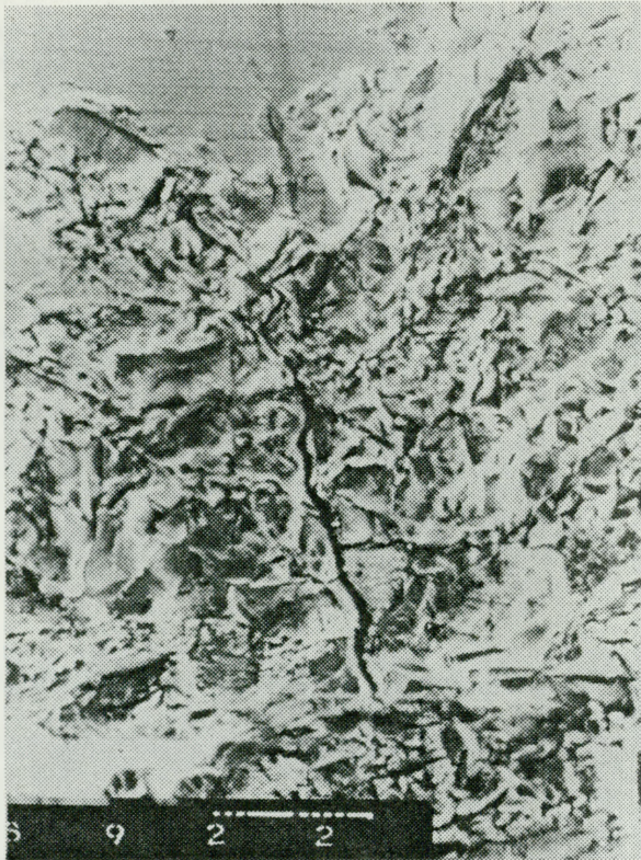
3. Warstwa żelowa (przekrój, SEM, powiększenie 500 x) 3. Gel layer (cross section, SEM, magnified 500 x)
