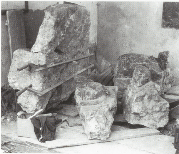
8. Płyta nagrobna J. Dobka Łowczowskiego — suchy montaż i skle- janie rozspojonych części korpusu. Stan z 1993 r. Fot W. Procyk
