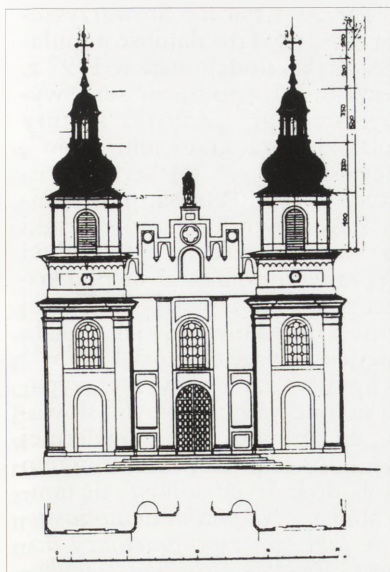
25. Braclaw, kościół parafialny. Dwie propozycje rysunkowe odbudowy wież, nawiązujące do barokowej tradycji regionu. Rys. arch. J. Skrzypczyk, 1996 r.
