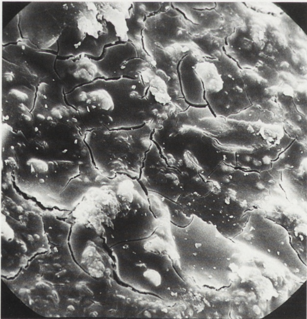
12b (SEM). Warstwa żelowanej żywicy krzemooorganicznej, spękanej na skutek dużego skurczu liniowego. Próba Y, powiększenie 700 x, widok z góry; wynik negatywny. Fot. R. Kopczyński
