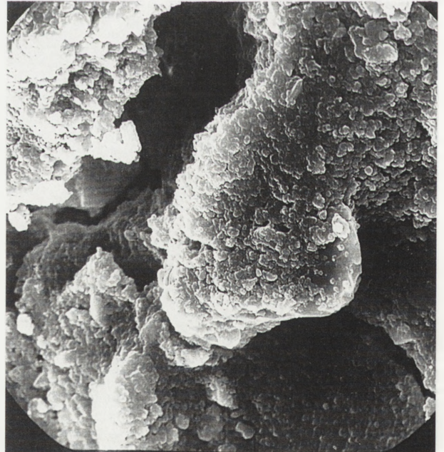
12c (SEM). Drobne minerały blaszkowe zespolone żywicą krzemooorganiczną, obserwowane w głębi struktur sekrecyjnych. Zachowana drożność kapilarna. Próba 2 — powiększenie 1600 x, przekrój. Fot. R. Kopczyński
