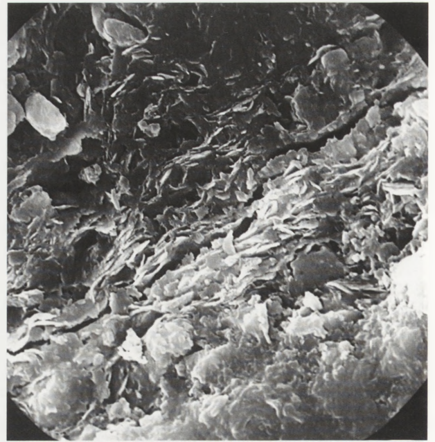
3. (SEM). Najbardziej niekorzystna konfiguracja mineralów pakietowych — prostopadła do powierzchni przekroju. Próba 19 — epitafium z Koszyc, powiększenie 180 x. Fot. R. Kopczyński
