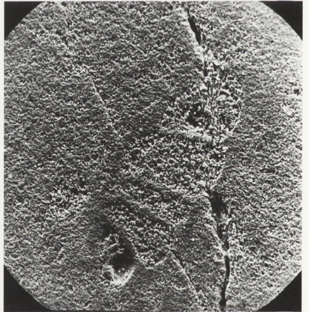
5. (SEM). System rezydualnych strumieni porów wypełnionych blaszkami mineralów ilasto-żelazistych, prostopadły do płaszczyzny przekroju. Próba 10 — kościół św. Stefana w Budapeszcie, powiększenie 180 x. Fot. R. Kopczyński
