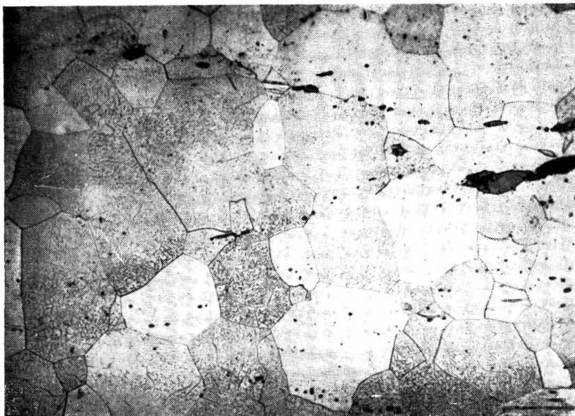
Fig. 4. Un "grompe" du groupe de fours à Mirogonowice. Ferrite à grandeur de grain différenciée. De nombreux nitrures apparaissent sur les grains. Attaque au nital. Grossissement: 250. Elaboré par E. Nosek
