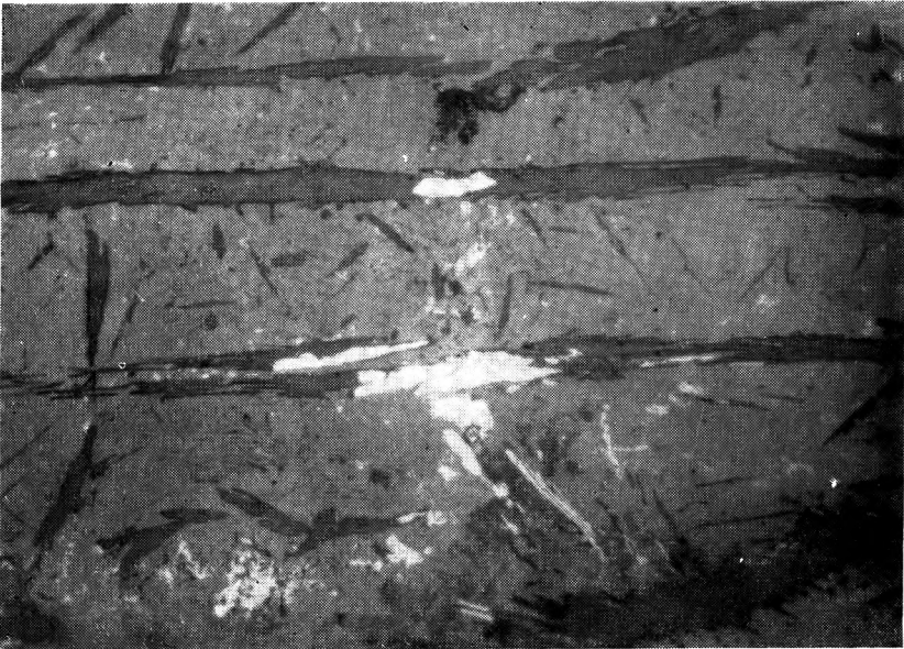
Fig. 7. Un "grompe" du groupe de fours à Wieloborowice. Une acicule de cémentite partiellement corrodée sur le fond d'une masse d'oxydes. Les endroits blancs se rapportent à la cémentite non-corrodée. Attaque au nital. Grossissement: 500. Elaboré par A. Mazur et E. Nosek
