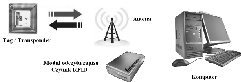
Rys. 1. Uproszczony schemat działania technologii RFID
