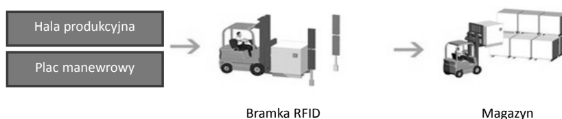
Rys. 2. Zastosowanie technologii RFID w procesie magazynowania
