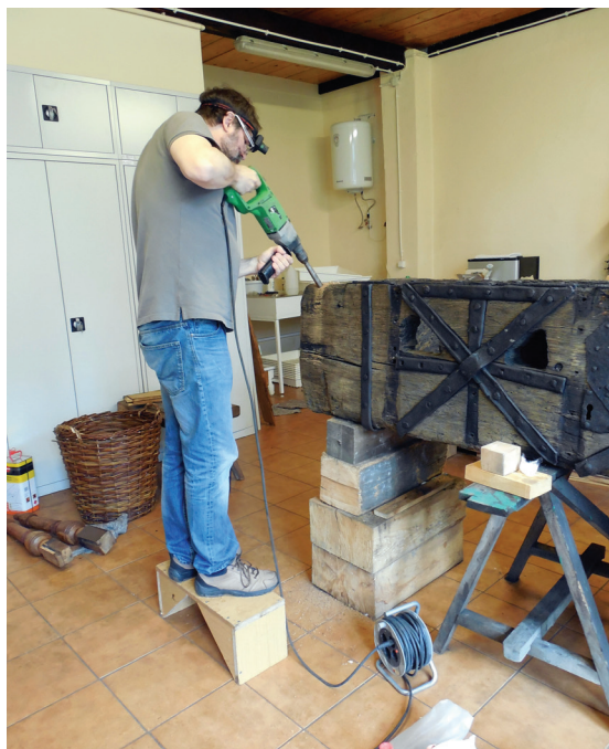
Fot. 7. Pobieranie próbki drewna do badań dendrochronologicznych
