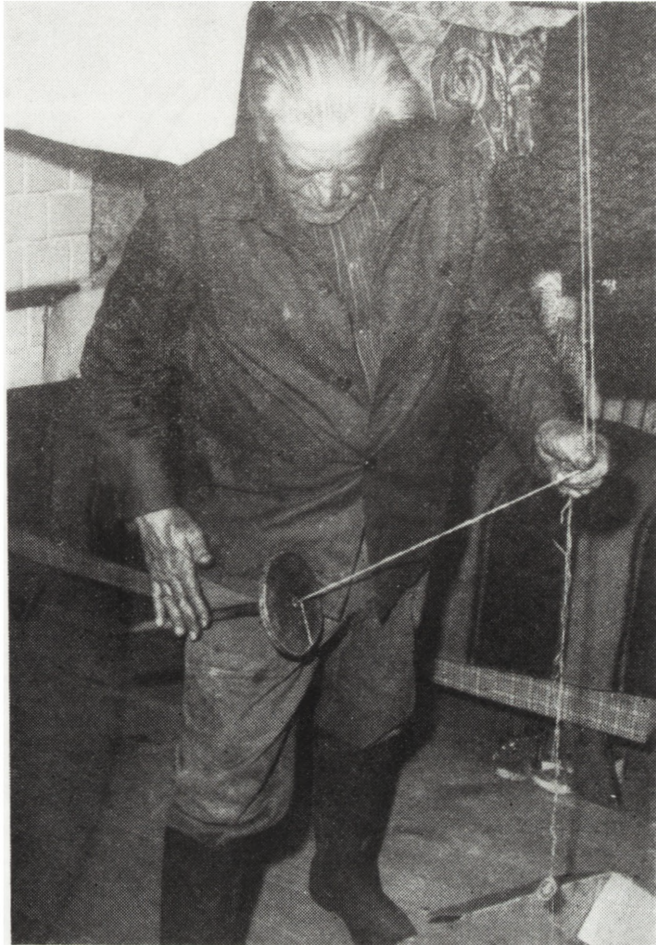
Ryc. 20. Sposob skręca- nia dratwy na kółku . Podmachocice
