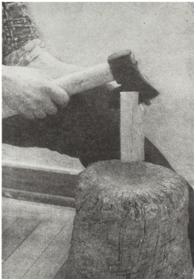
Ryc. 2. Łupanie brzo- wej ćwiarteczki na półki. Podmachocice
