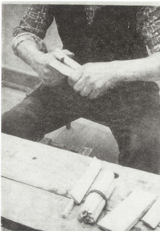
Ryc. 3. Łupanie nożem półki brzozonej na półtecki. Podmachocice
