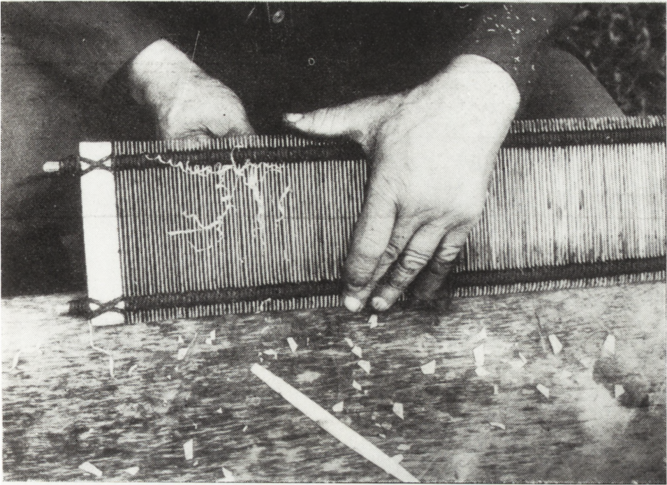
Ryc. 18. Struganie, zrzynanie krawędzi trestek . Podmachocice
