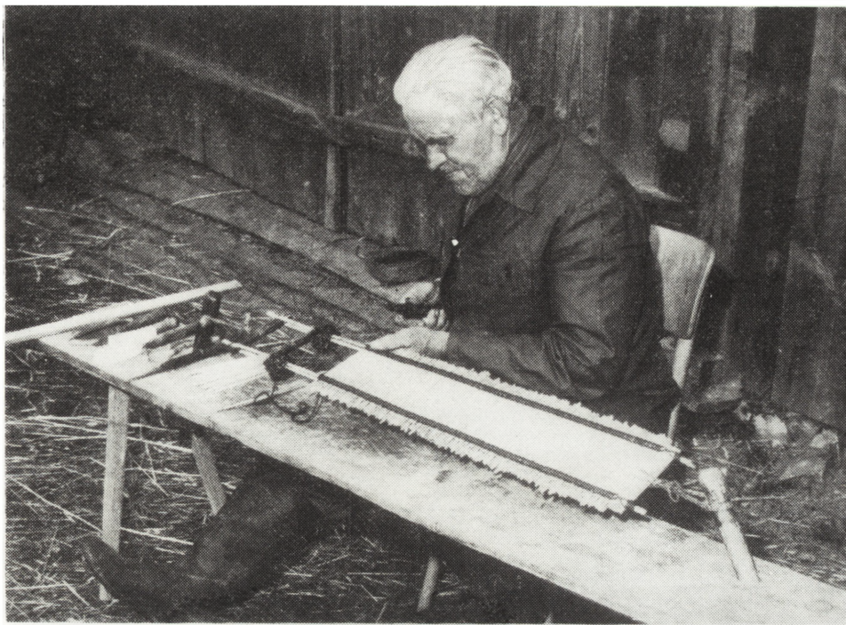
Ryc. 10. Montaż, zawijanie płochy; widoczny sposób umocowania ramy konstrukcyjnej na kółkach csadzonych w ławie. Podmachocice, warsztat Józefa Siudaka
