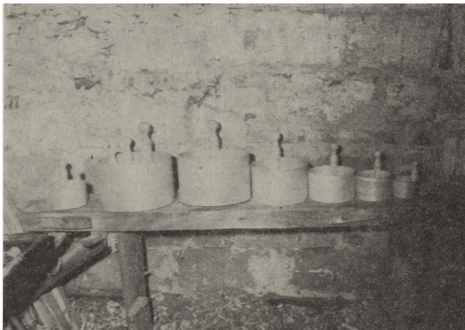
Ryc. 12. Gotowe miarki z warsztatu Zygmunta i Antoniego Anielskich: dwugarn-cówka, garncówka, półgarncówka, kwarta i półkwarta . Z lewej, sposób składania miarek do transportu
