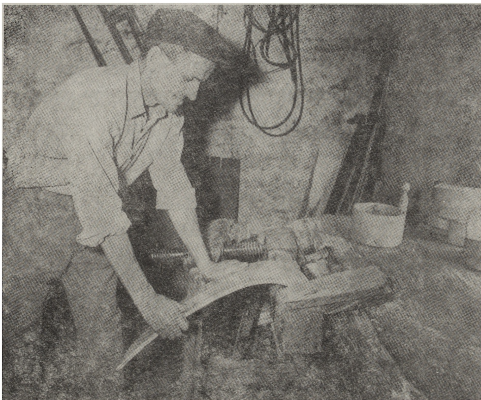
Ryc. 6. Zygmunt Anielski demonstruje sposób gięcia obłąków na zaginaczu
