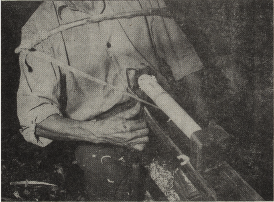
Ryc. 15. Profilowanie gałki trzonka, Skalbmierz
