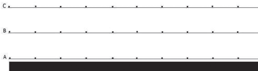
Ryc. 1. Schemat rozmieszczenia próbek na liniach A, B i C (na czarno zaznaczona jest powierzchnia ścieżki turystycznej, punkty rozmieszczone na liniach A, B i C to próbki w kształcie kwadratu o powierzchni 0,1\text{ m}^2 )
