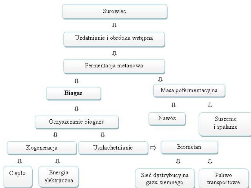
Rys. 1. Uproszczony schemat technologiczny produkcji i wykorzystania biogazu
