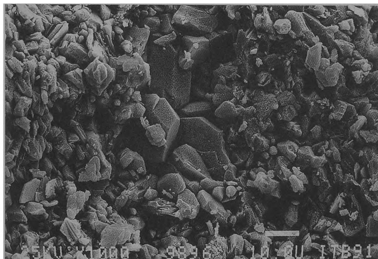
Rys. 6. Posadzka, krystalizacja gipsu w porze, SEM, powiększenie 1000x
