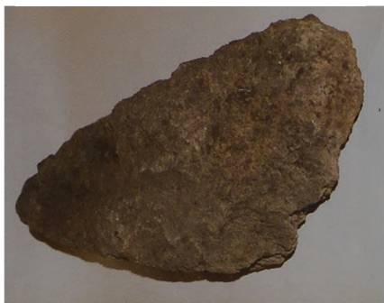
Ryc. 4. Klin zwornikowy z martwicy wapiennej (16) (fot. A. Ziółkowski)
