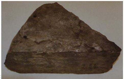
Rys. 3. Klin zwornikowy z granitu (15) (fot. A. Ziółkowski)
