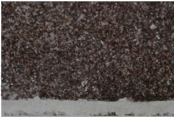
Ryc. 8. Granodioryt: a – glaz narzutowy, b – cios w kolegiacie, c – obraz z mikroskopu polaryzacyjnego przy pojedynczym nikolu, d – obraz z mikroskopu polaryzacyjnego przy skrzyżowanych nikolach (c i d – powiększenie 25x)
