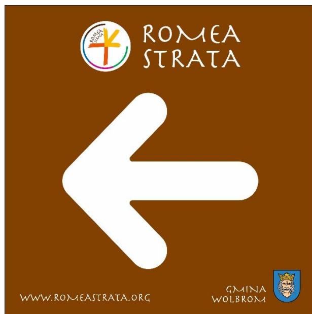
Ryc. 2. Szablon znaku drogowego określającego przebieg szlaku Romea Strata. Znak drogowy umieszczony na drogach publicznych, wykonany z blachy stalowej ocynkowanej grubości minimum 1,25 mm, z podwójnie giętymi krawędziami i dane identyfikujące producenta znaku. Lico znaku jest wykonane techniką drukarską na folii odblaskowej ( Instrukcja znakowania szlaków turystycznych , Wydawnictwo PTTK „Kraj”, Warszawa 2014)
